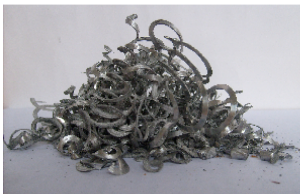
Рис. 1в. Стружка алюминиевая (спирали)
