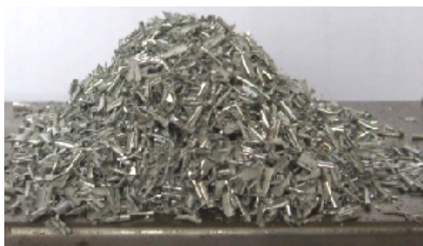
Рис. 1а. Стружка алюминиевая (изогнутые пластинки)
