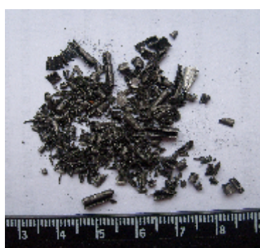
Рис. 2. Чугунная стружка: а – элементная «крупная»; б – элементная «мелкая»; в – стружка после термической обработки в ротационной наклоняемой печи
