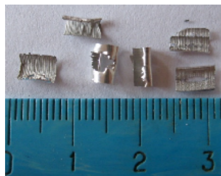
Рис. 1а. Стружка алюминиевая (изогнутые пластинки)
