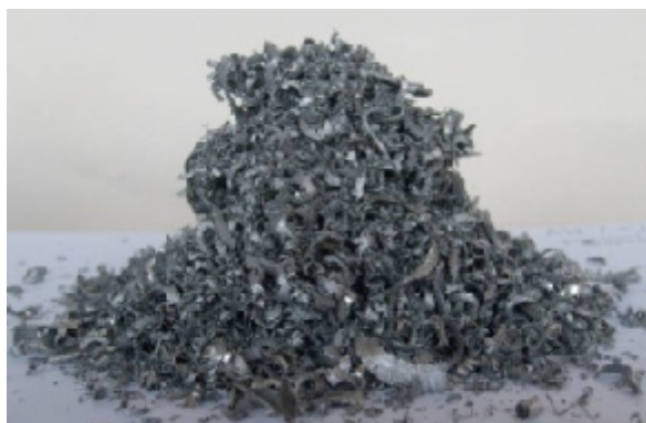
Рис. 1д. Стружка алюминиевая (смесь пластинок, витков и их фрагментов)
