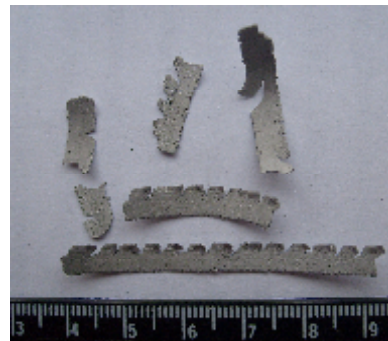
Рис. 1г. Стружка алюминиевая (полоски)
