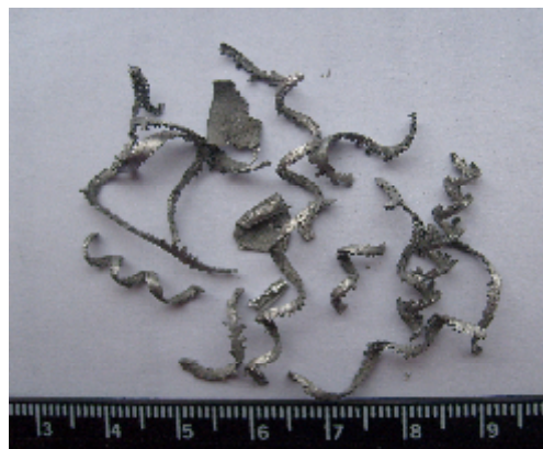
Рис. 1б. Стружка алюминиевая (смесь витков, пластинок и их фрагментов)
