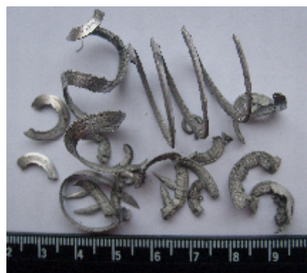
Рис. 1б. Стружка алюминиевая (смесь витков, пластинок и их фрагментов)
