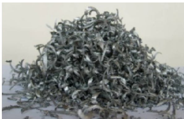
Рис. 1б. Стружка алюминиевая (смесь витков, пластинок и их фрагментов)
