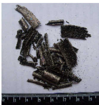
Рис. 2. Чугунная стружка: а – элементная «крупная»; б – элементная «мелкая»; в – стружка после термической обработки в ротационной наклоняемой печи
