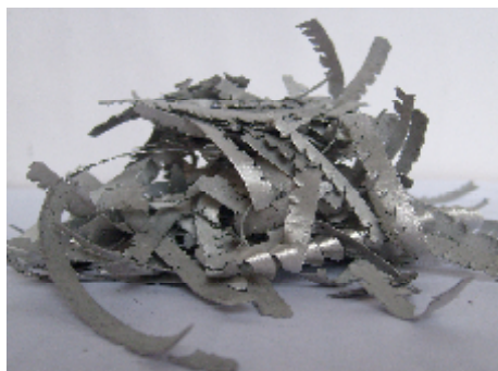
Рис. 1г. Стружка алюминиевая (полоски)
