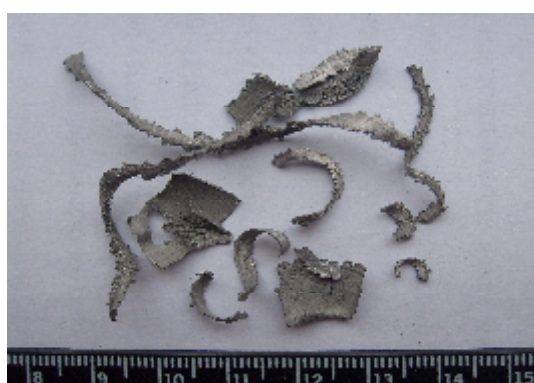
Рис. 1д. Стружка алюминиевая (смесь пластинок, витков и их фрагментов)
