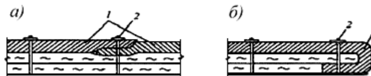
Рисунок 28 - Соединение полотен рулона способом поджатия
