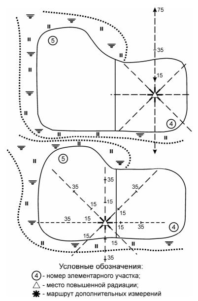
Рис. 2. Схема измерения гамма-фона по 8-румбовой сетке
