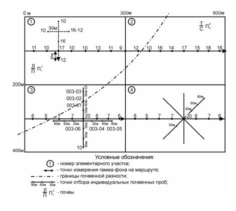
Puc.1. Схема дополнительных измерений и отбора индивидуальных почвенных проб при повышенных значениях гамма-фона
