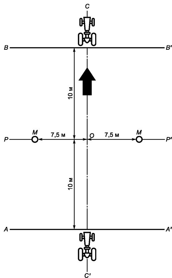
*СС — траектория движения трактора; М — место расположения микрофонов; А—А' и В—В' — границы измерительной площадки, по которой трактор движется в режиме разгона; Р—Р' — центральная линия разметки площадки; О — центральная точка разметки измерительной площадки*
