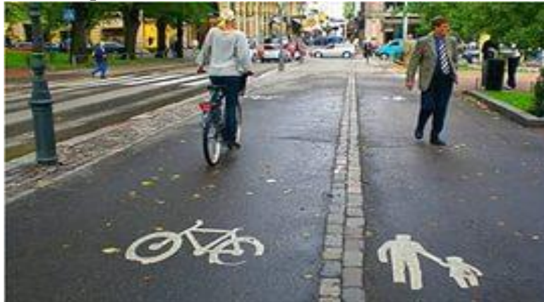
Рисунок 54. Разделение велосипедных и пешеходных потоков.
