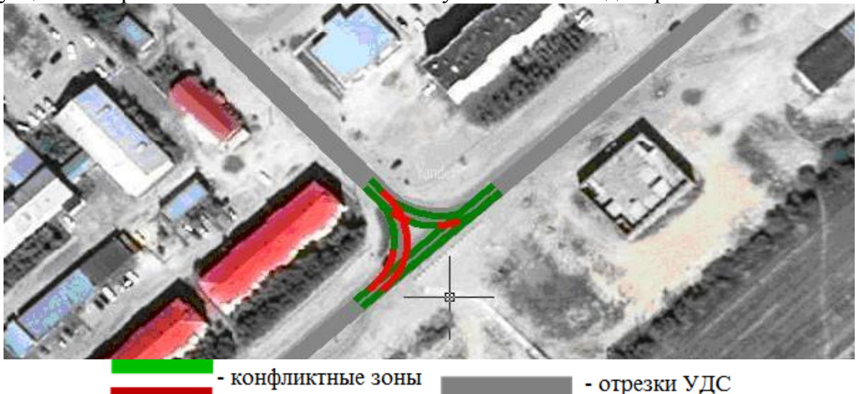
Рисунок 43. Правила проезда в конфликтных точках пересечения
