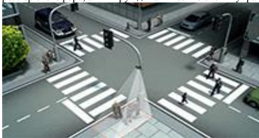
Рисунок 53. Обнаружение пешеходов оптическим датчиком и активация предупредительной световой сигнализации
