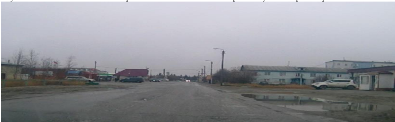
Рисунок 7. Улица Иванникова. Отсутствие тротуаров и бордюрного камня справа. Отсутствие водоотвода с поверхности проезжей части. Отсутствие дорожной разметки. Дефекты покрытия
