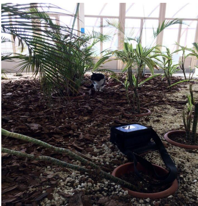
Рисунок 2.9 – общий вид газоанализатора «Комета» в процессе определения концентрации газов внутри рабочего помещения сооружений биологической очистки 02.04.2017 г.
