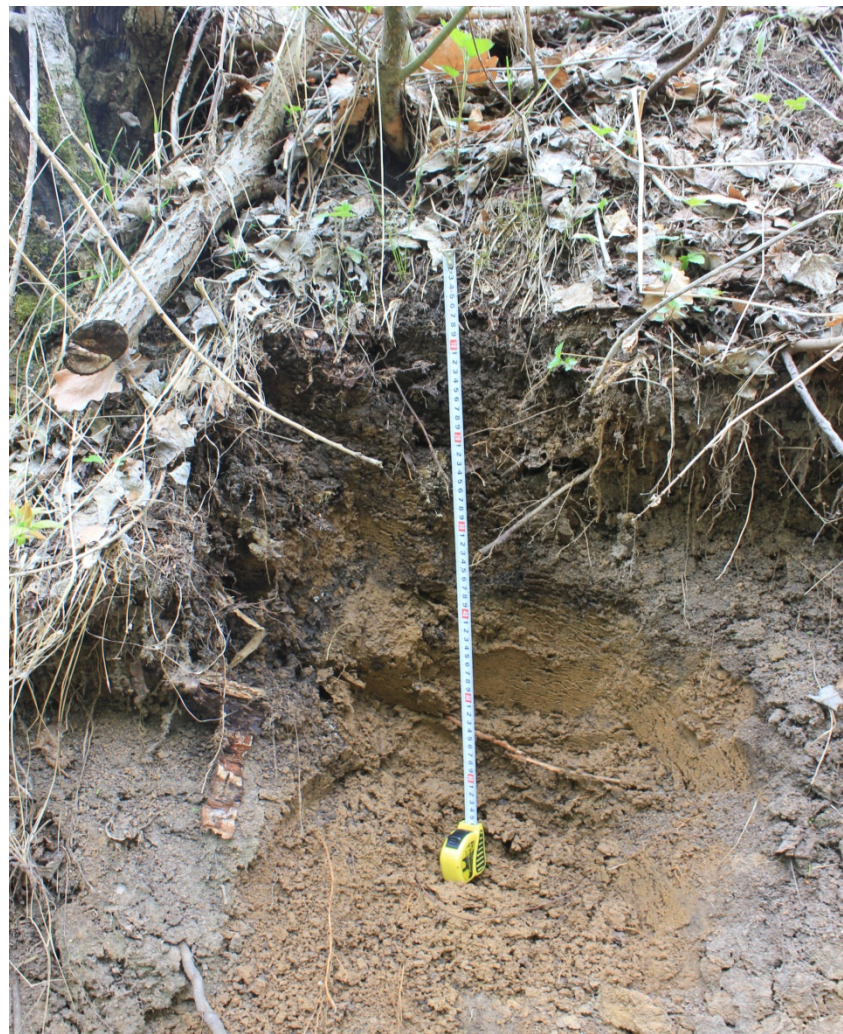
Некачественно подготовленный разрез
