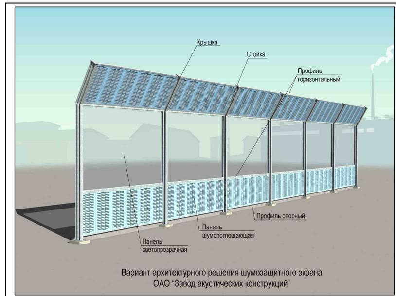
4. Применение в качестве покрытия шумопоглощающих панелей невыцветающего долговечного полиуретанового покрытия.
